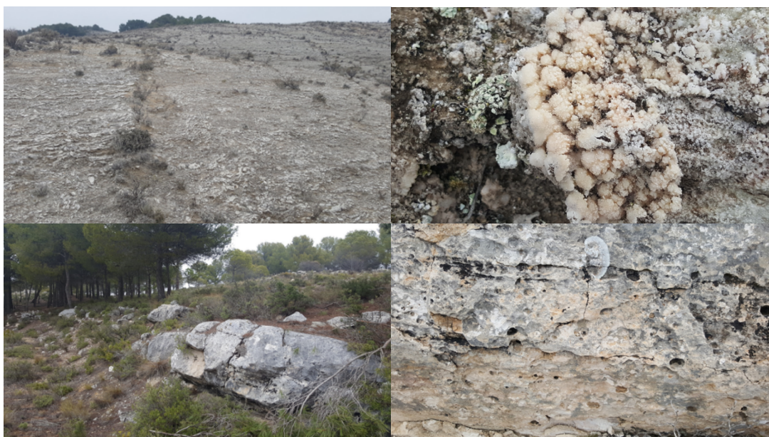
Figuras 9. Arriba, formaciones yesíferas aflorantes donde se observa en superficie las fracturas e incrustaciones de cristales de yesos. Abajo, aspecto de las formaciones carbonatadas, dispuestas por encima de los materiales yesíferos.
