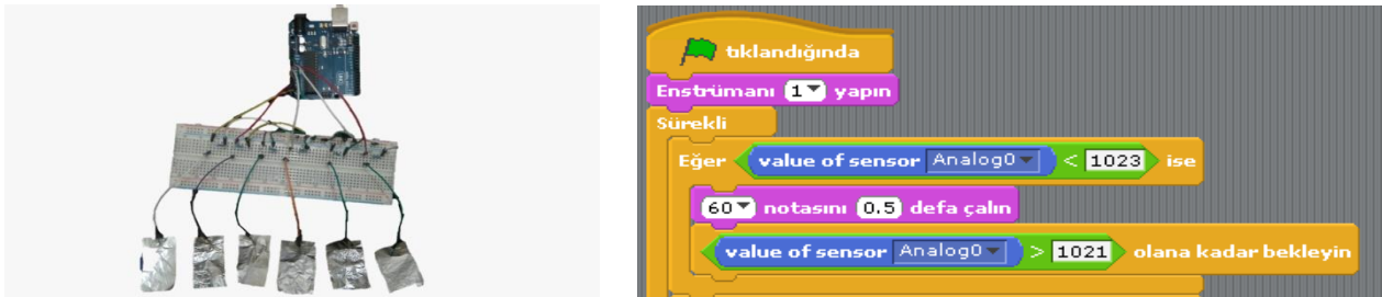
Şekil 6. Arduino ve Scratch ile Pişano Projesi ve örnek kod blokları
