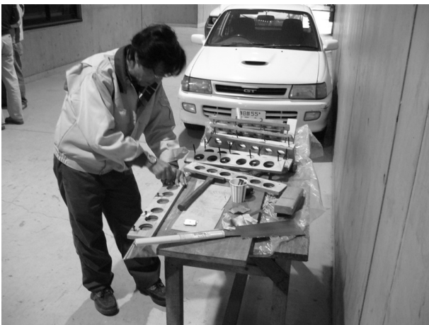
図 6 フロート支持部のための内部補強板の製作。スプレッダーとの締結ボルトはこの補強板に裏側から圧入接着した。
