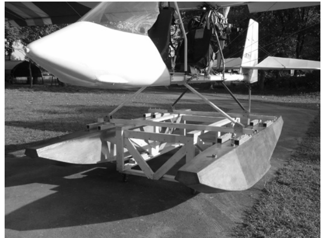
図11 フロートの装着状況
