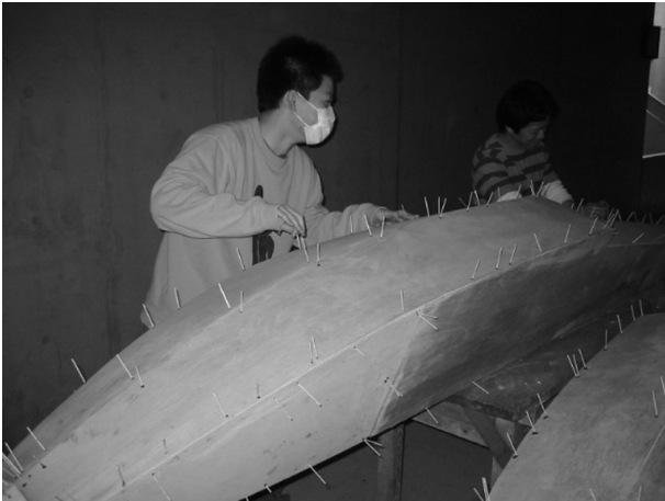
図8 外板を仮止めした細釘穴の処理
