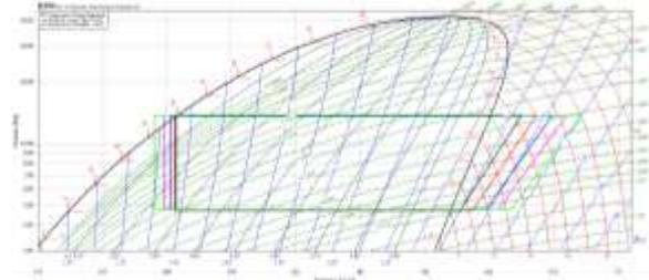
Gambar 8 Plot kerja sistem AC unitary tanpa LSHX dan dengan LSHX pada temperatur kondensasi 40°C
