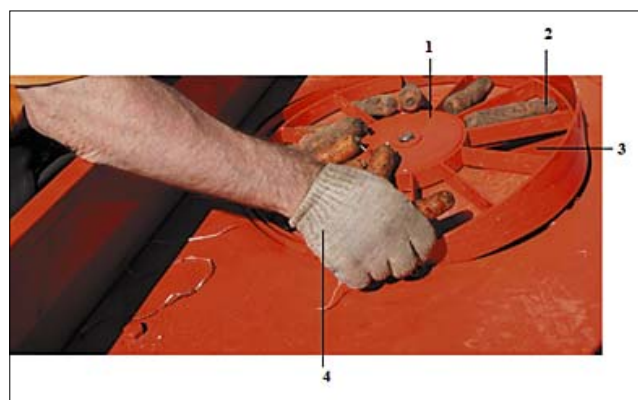
Рис. 3. Укладка корнеплодов оператором в ячейки высаживающего диска машины:
