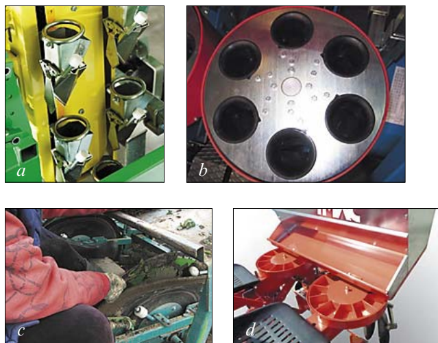
Рис. 1. Типы высаживающих аппаратов: а – высаживающий конус; б – револьверный; с – эластичные диски; д – горизонтальный ячеистый диск Fig. 1. Types of planting units: а – planting cone; б – revolving; с – elastic disks; д – horizontal cellular disk
