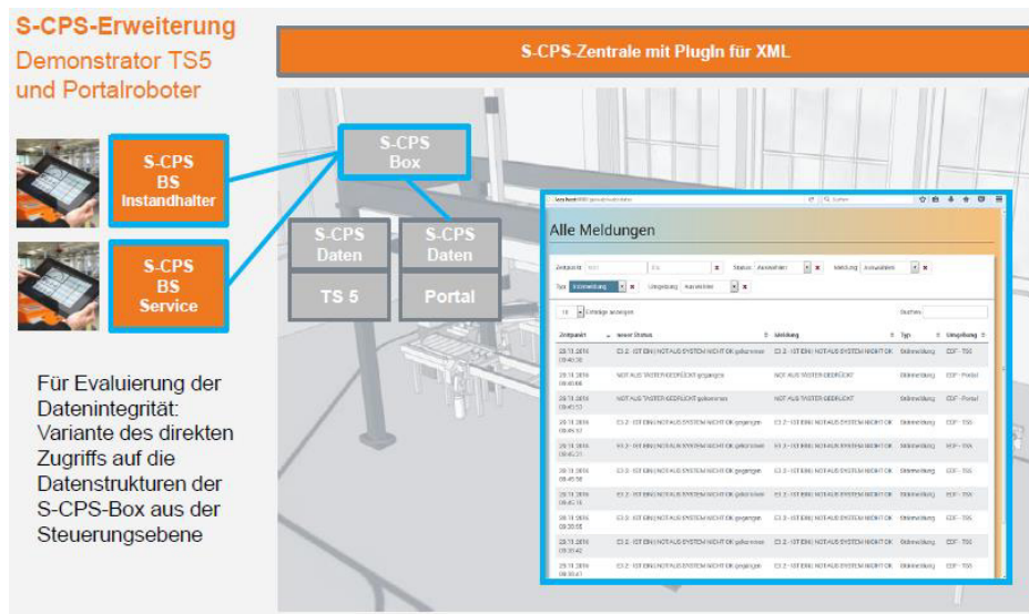
Abbildung 18: Portal- und TS5-Daten-Visualisierung direkt auf der S-CPS-Box
