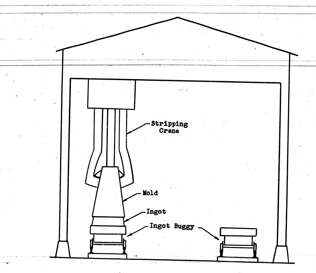
Figure 2 STRIPPING OPERATION
