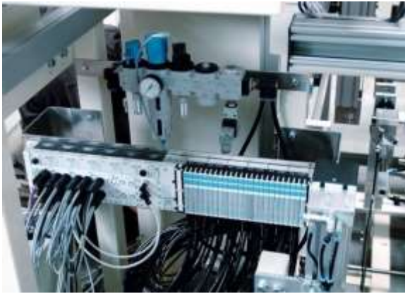
Рисунок 6 – Пневмоострів «Festo» у системі керування технологічним процесом виробництва пластмасових виробів
