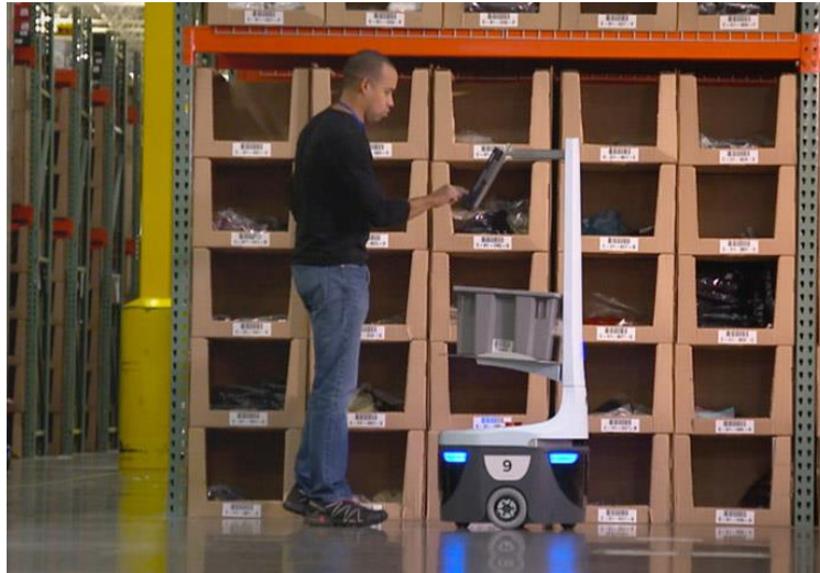
Figura 3. 16. Un trabajador de almacén valida la carga depositada en LocusBot. Recuperado de: http://www.digitaltoo.com/2017/04/10/robots-dhl-localizacion-recogida-productos/
