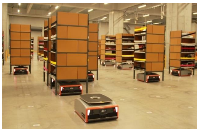
Figura 3. 13. Empleo de AGV en la gestión de almacenes con GreyMatter (GreyOrange, 2019)
