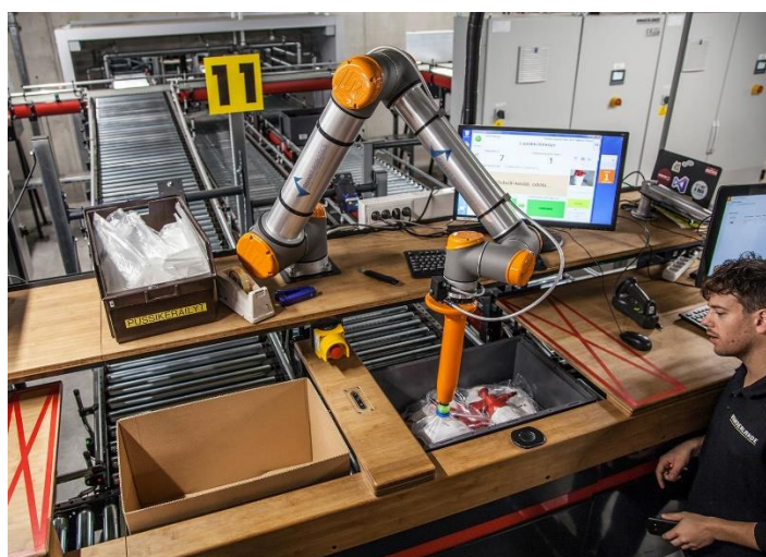
Figura 3. 15. Robot colaborativo SIR en funcionamiento junto a un trabajador (Schilperoort, 2018)
