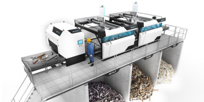
Figura 3. 4. Máquina de reciclaje de ZenRobotics (Gesing, Peterson, & Michelsen, 2018).
