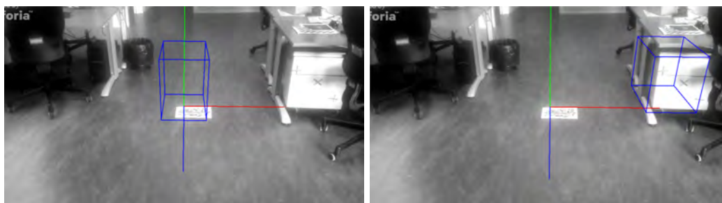
FIGURE 6.3 – Projection d’un parallélépipède de 50 \times 30 \times 50 dans l’image. Les dimensions correspondent à la desserte à droite de l’image.
