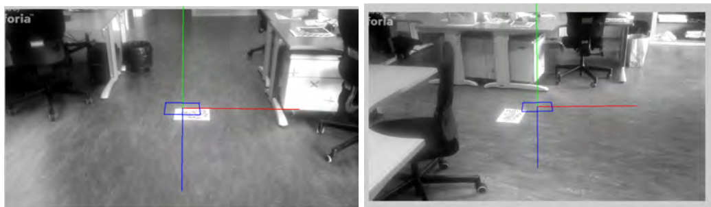
FIGURE 6.2 – Exemple de résultats obtenus par notre méthode inertielle pour la projection d’une feuille A4 virtuelle. Ici, la feuille A4 blanche au centre ne sert que de comparaison.
