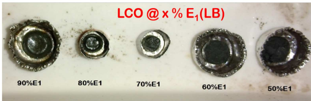
Figure 2.24 : : tests de fusion en creuset de platine, exemple des échantillons \text{LCO}@x\%E_1(\text{LB}) .
