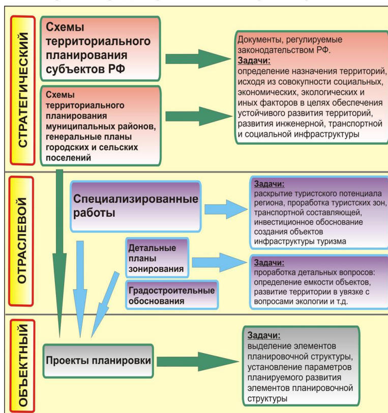
Рис.1. Уровни градостроительного проектирования
