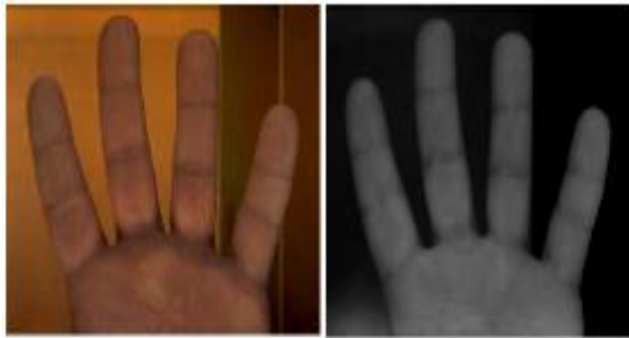
Figura 15. Funcionamiento del sistema PRM233cbigeye. Imagen captada en Banda visible (izquierda) e infrarroja (derecha). 31
