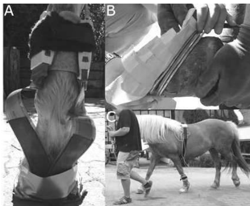
Abb. 1: Instrumentalisierung des Hufes für die Untersuchung(A); Anbringung der zwei Sensoren am Huf (B); Kinetische Untersuchung auf Betonboden (C)
