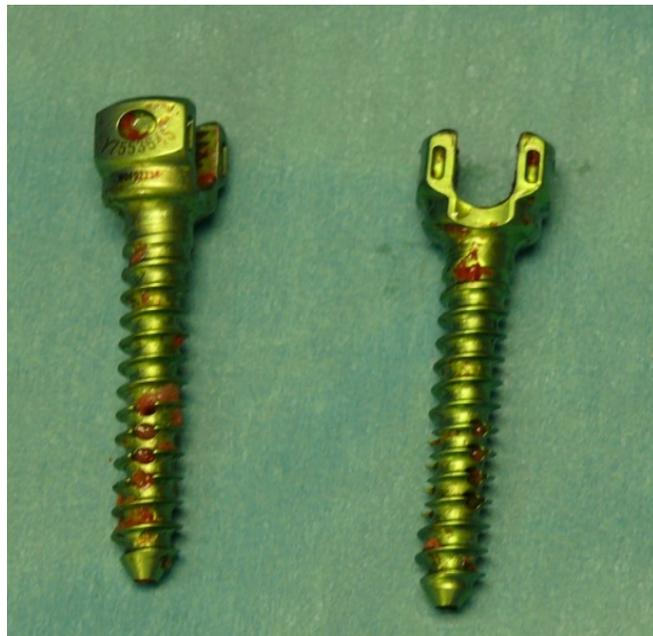
Abbildung 03: Pedikelschrauben 6,5x45mm (CD HORIZON® LEGACY™ FNS Fenestrated Screw, Medtronic, Memphis, USA) nach Explantation aus dem Kadavermodell mit verbliebenen Geweberesten im Bereich der Fenestrierungen und des Gewindes
