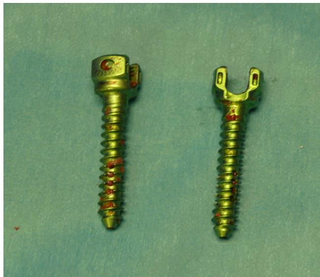
Abbildung 18: Pedikelschrauben nach Entfernung aus dem Zementverbund. Bei den Gewindeauflagerungen handelt es sich um Gewebereste
