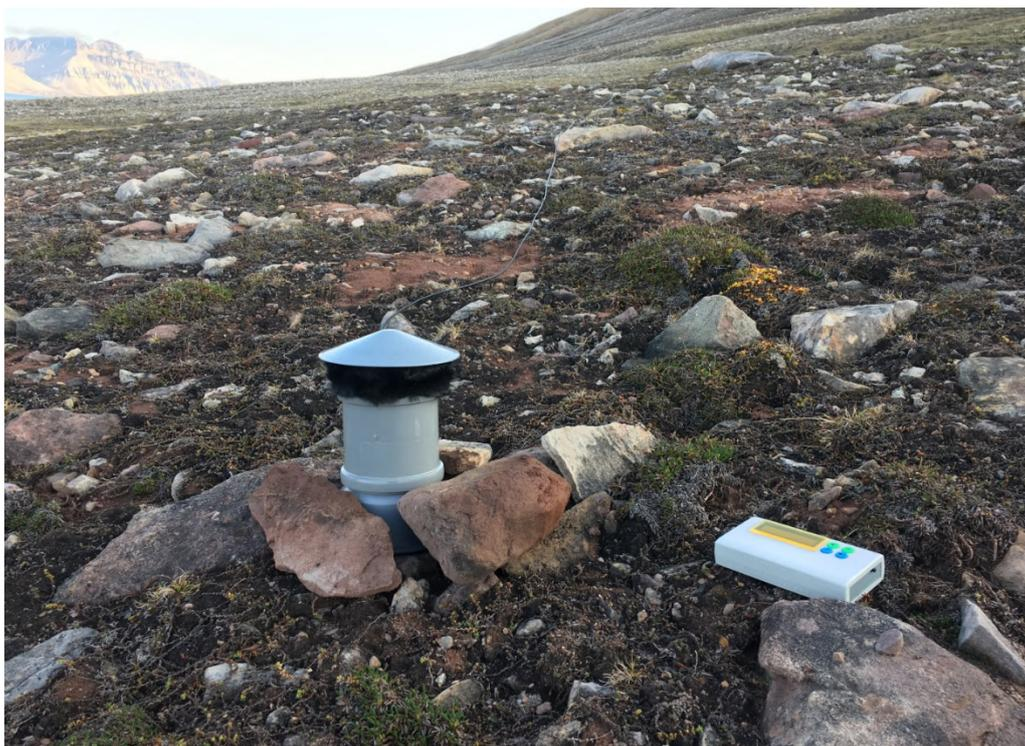
Рис. 15. Пример установки микрофона на местности в ветрозащитном кожухе
