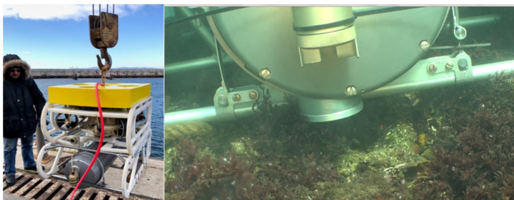
**Рис. 3.** Проведение натурных испытаний подводного мобильно-робототехнического комплекса по определению химического состава воды в реальном времени в береговых и прибрежных районах Амурского залива для развития сетевых подспутниковых наблюдений и систем многоуровневого мониторинга
