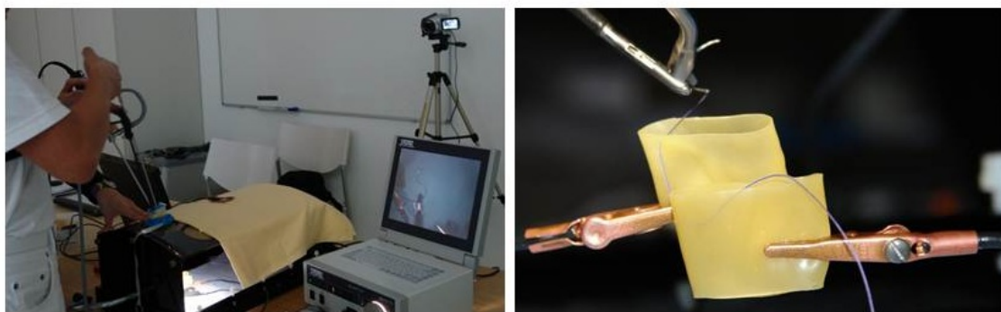
Abbildung 14: Links: Versuchsaufbau mit 1-Trokar Zugang. Rechts: Im Pelvitrai-ner eingespanntes Phantom zum komplexen Nähen mit gewinkelten laparoskopischen Instrumenten.
