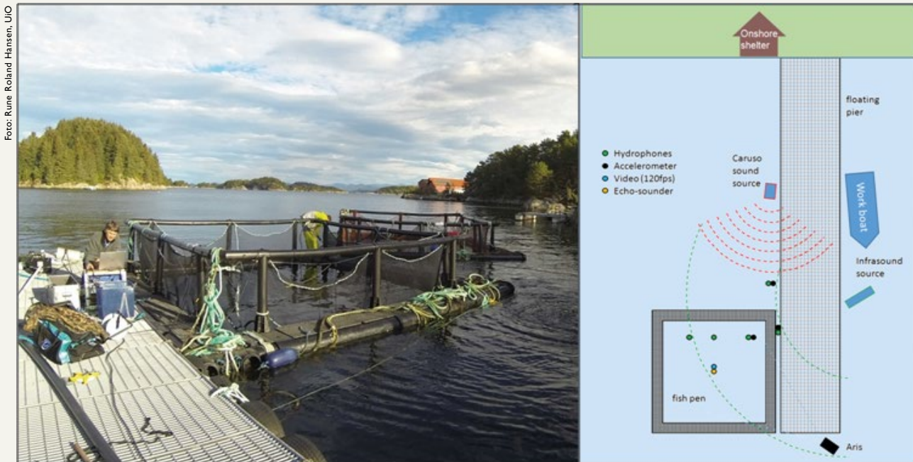
Figur 1. Feltarbeid på Austevoll. Bildet til venstre viser merden som ble brukt. Hydrofon og sensor for partikkelbevegelse ble registrert på en PC satt opp rett ved merden. Ekkolodd, høyfrekvent sonar og begge lydkildene ble kontrollert fra en liten hytte på land, som vist i skisse til høyre. Her er også vist plassering av ekkolodd og kamera-rigg; midt i merden på 4,5 meters dyp, plassering av hydrofoner og sensor for partikkelbevegelse inne i og utenfor merden, samt plassering av de to lydkildene.
