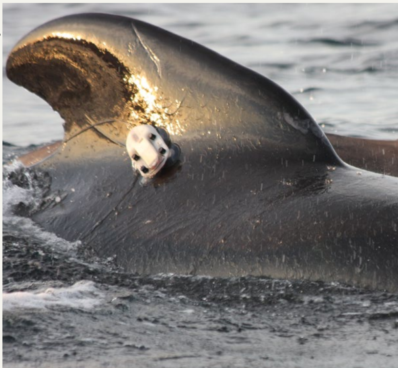
Figur 1. For å kunne se hva grindhval og andre hvalarter gjør når de hører lyden av fregattsonar blir de merket med et elektronisk merke (D tag) som festes til hvalens rygg med sugekopper. Merket sitter på i 18–20 timer før det løsner, og forskerne kan plukke det opp for å laste ned de innsamlete dataene.
