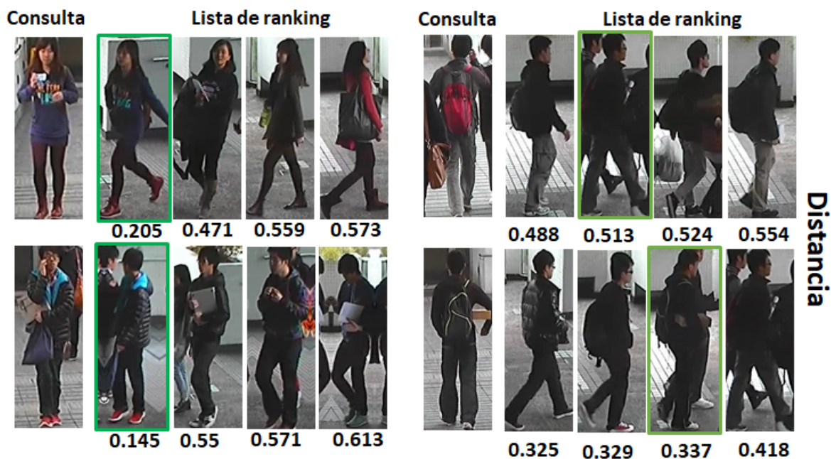
Figura 5.9: Imágenes en verde corresponden al emparejamiento de la consulta y la galería. En la parte izquierda el modelo predice correctamente y en la derecha el emparejamiento se da entre las 4 imágenes con menor distancia.
