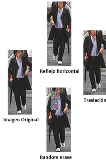
Figura 4.4: Transformaciones utilizadas para el incremento de imágenes (CUHK01).
