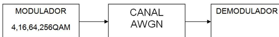
Figura 5.1.: Sistema de Comunicaciones con canal AWGN
