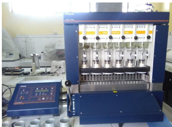
Figura 69: Determinación de grasas en las harinas
