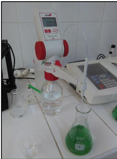
Figura 77: Titulación de las muestras (harina y pan integral).
