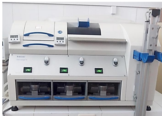
Figura 73: Evaluación extensográfica de las harinas.
