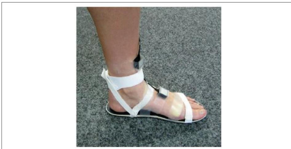
Figure 4.3 Solution de sandale instrumentée équipée de capteurs piézocapacitifs et de deux stations inertielles
