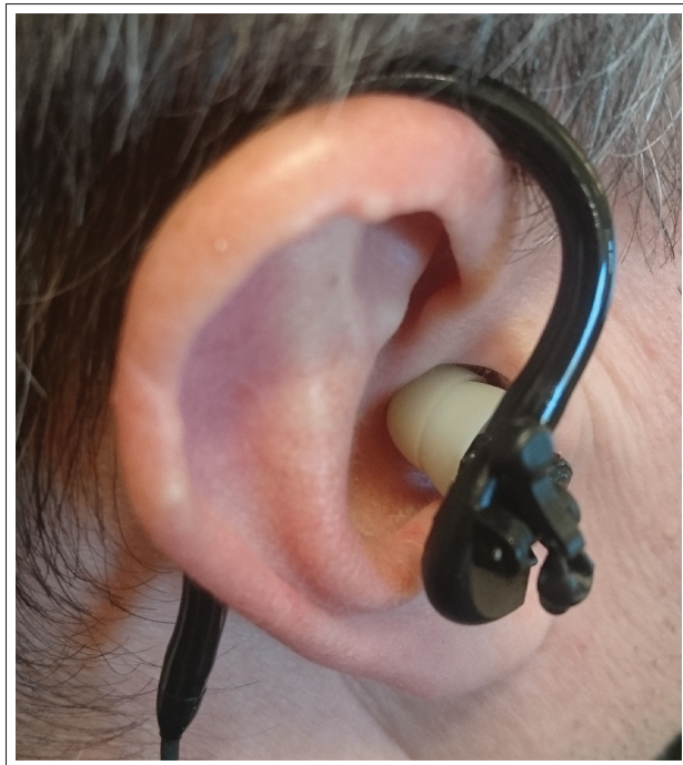
Figure 5.1 Exemple de port du bouchon dosimétrique lorsque celui-ci est retiré du conduit auditif. Le microphone de mesure est maintenu à proximité de l'entrée du conduit auditif, mais l'atténuation procurée par le protecteur est grandement réduite (voir figure 5.3)
