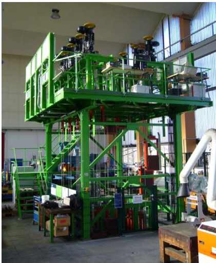
Abbildung 10 Prüfstand für Magnettreibscheiben
