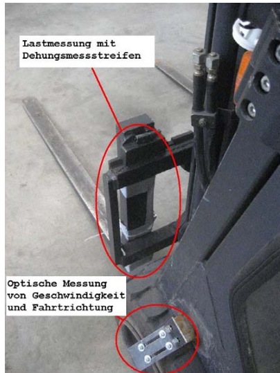
Abbildung 3: Messung von Lastschwerpunkt, Fahrzeuggeschwindigkeit und -fahrtrichtung [4]
