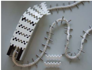
Abb. 6: Muster gewirkte Trageilketten mit Führungsprofil und Tragplatten [Quelle TU Chemnitz]
