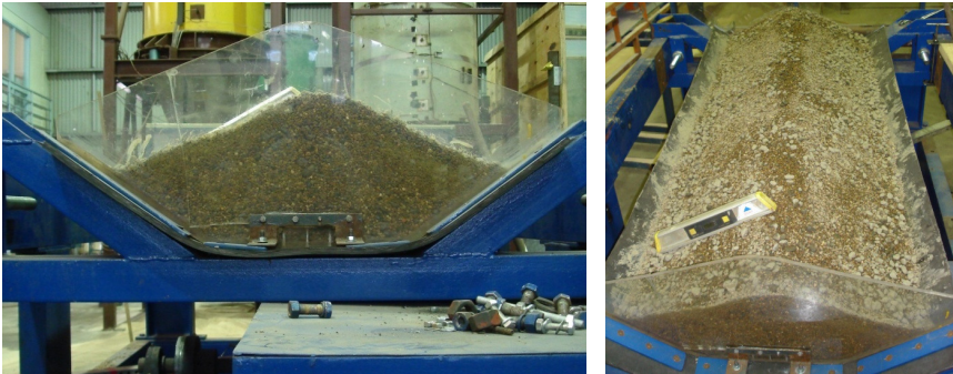
Abbildung 1: Versuchstand (beladen) mit quasi eingespanntem Gurtende
