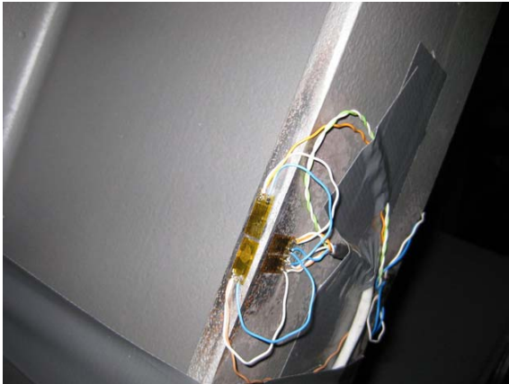
Abbildung 8: Messungen der Dehnungen an einer Speiche mit Dehnungsmessstreifen
