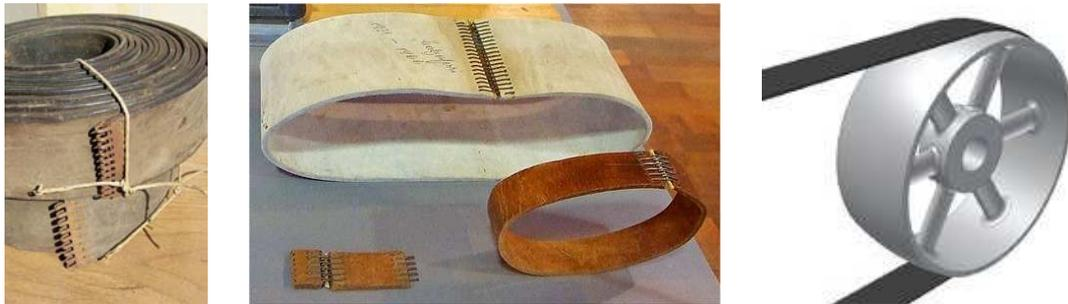
Wenn sich bei einem Riementrieb beide Räder im gleichen Sinn bewegen, spricht man von einem offenen Riementrieb. Bei umgekehrtem Sinn bzw. Rotationsumkehr wird der Riemen in Form einer 8 aufgezogen und das heißt gekreuzter Riementrieb. Es gibt noch weitere Riementriebe mit unterschiedlichen Riementypen, z.B. geschränkte Riemenführung mit Rundriemen oder Keilriemenantrieb.
