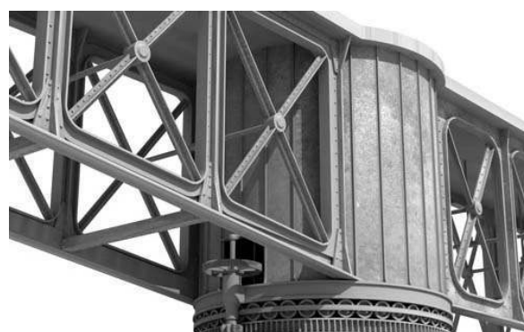
fig. 2. (ci-dessus) - Le mécanisme de rotation du pont tournant (1867) (auteur : S. Sire, [Laubé & Sire, 2007]) À gauche, en rouge, le cabestan déployé et mis en action par les agents de la direction du port. La volée est posée sur les rouleaux et on aperçoit un des engrenages en bleu. À droite, la volée a été enlevée. Le cabestan (en rouge) entraîne un petit pignon qui engrène sur le pignon bleu qui engrène à son tour sur la crémaillère afin d'opérer la rotation de la volée.
