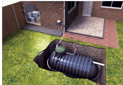
Obrázek 21: příklad plastové retenční nádrže [34]
