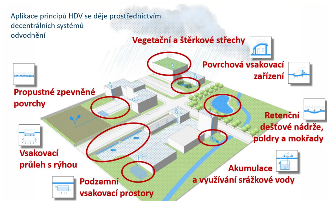
Obrázek 24: Přehled zařízení k HDV na stávajících stavbách [38]
