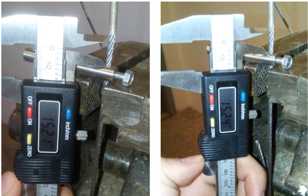
Obr. 5.16 Kontrola posunutí - před zatížením (vlevo) a po testování (vpravo)
