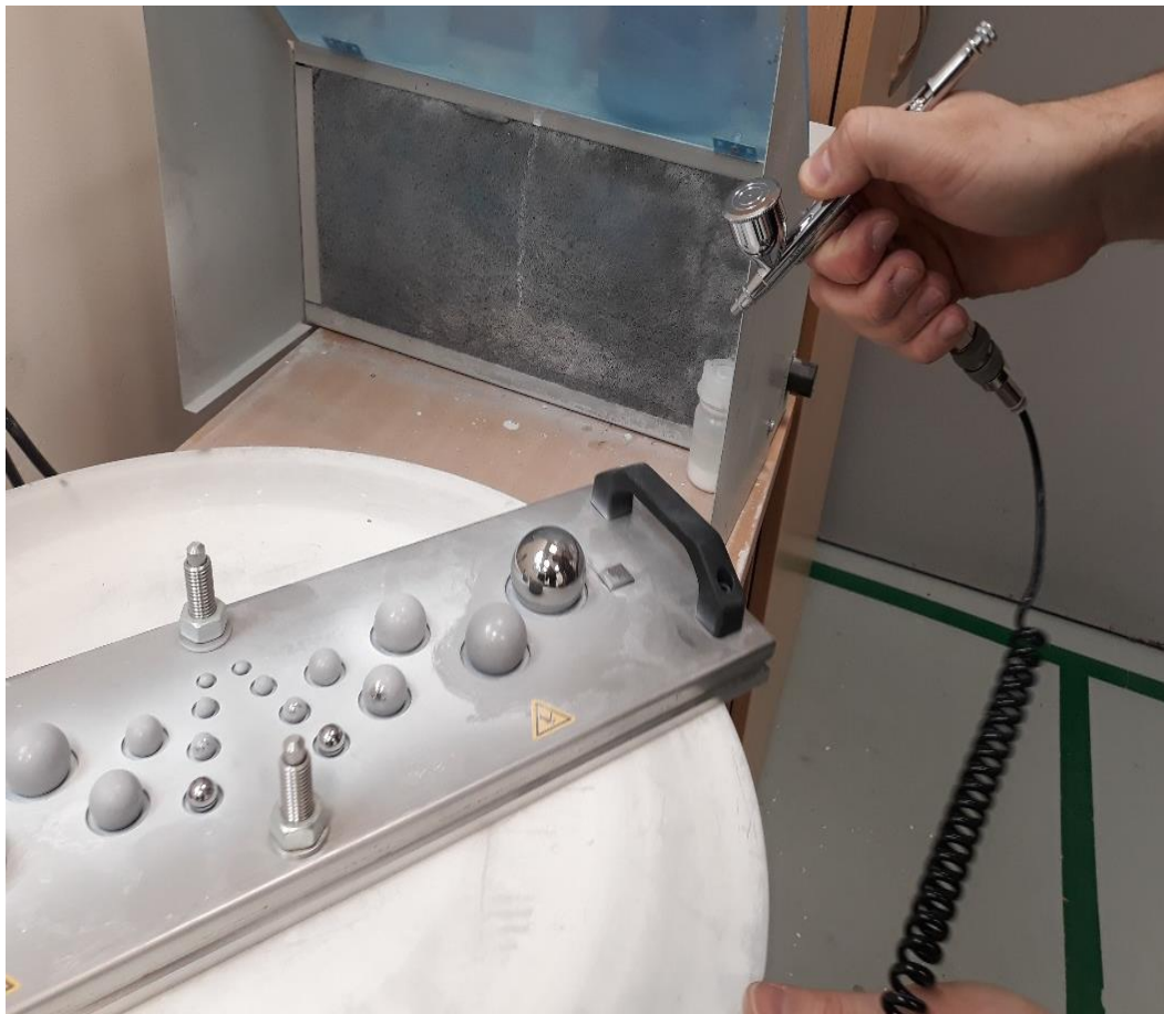
Obrázek 5.4 - Provádění nástřiku matného prášku
