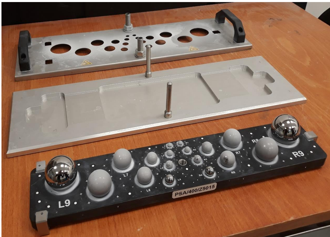
Obrázek 5.3 - Měřené součásti s přípravkem pro nástřik sfér
