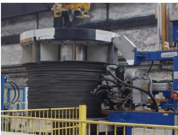
Obr. 25 Vázání cívky ocelovou páskou [21]
