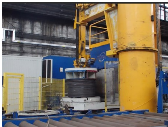
Obr. 24 Přesun cívky na stanoviště vazačky [21]
