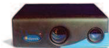
Figure 1.1 Numériseur 3D Capturor de Creaform Inc. (tirée du laboratoire LIV4D).
