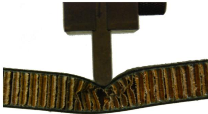
Figure 6-7 Exemple de rupture par indentation de la peau supérieure.
