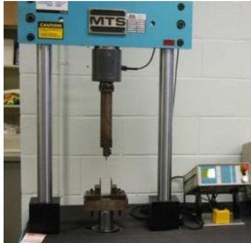
Figure 4-4 Machine de tests statique avec montage de flexion.
