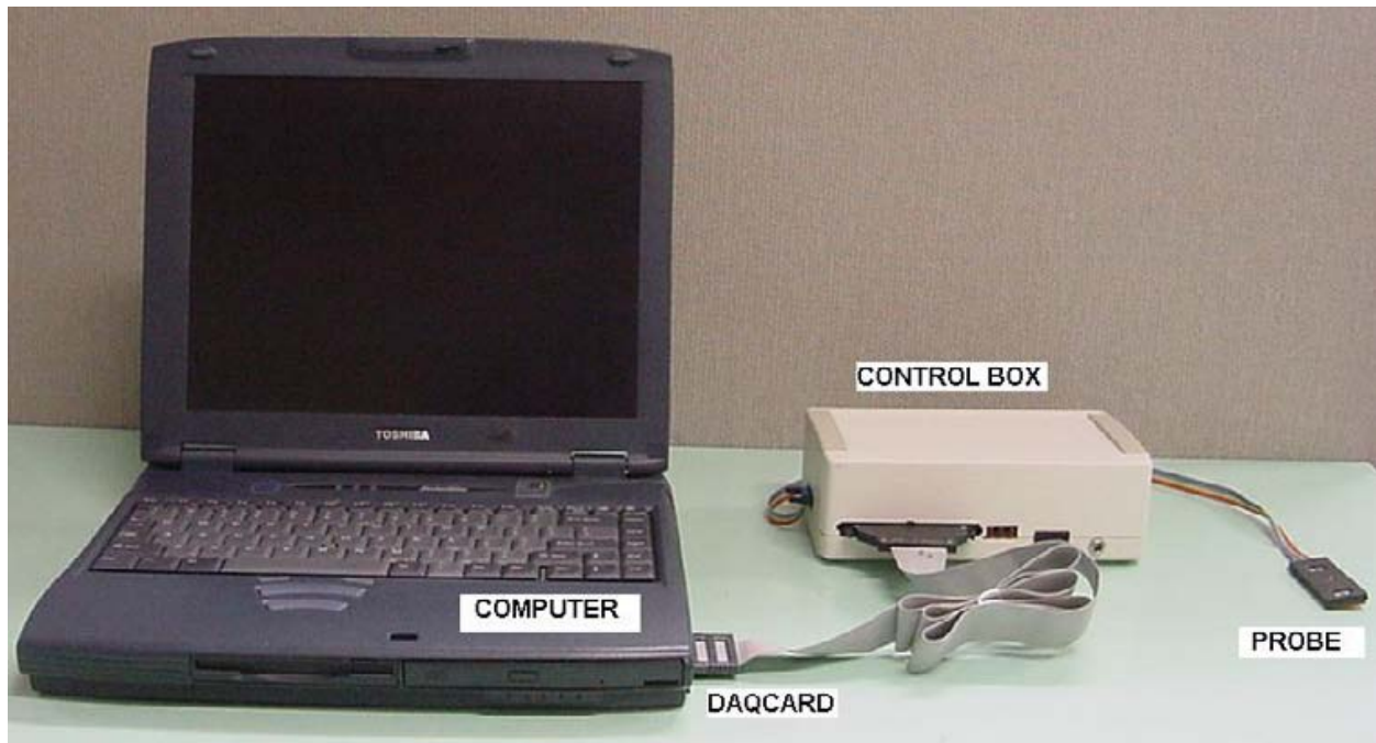
Figure 2-1: Appareil de NIRS portable dédié aux nouveau-nés provenant de Drexel University, tiré de [64]. Ce système utilise des détecteurs de faible sensibilité et n'a qu'une seule source de lumière et deux détecteurs, soit 2 canaux de mesure.
