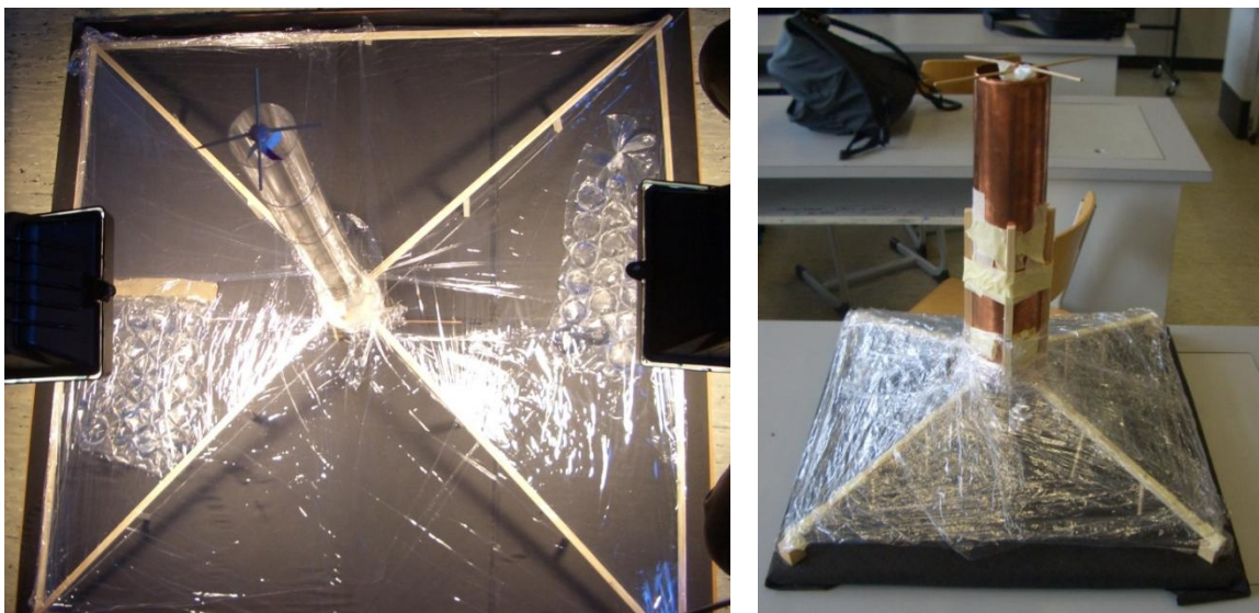
Abb. 22: Aufwindkraftwerke mit Kollektoren aus Frischhaltefolie
