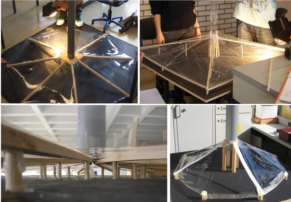
Abbildung 20: Aufwindkraftwerke mit verschiedenen Kollektorstützen aus Holz.
