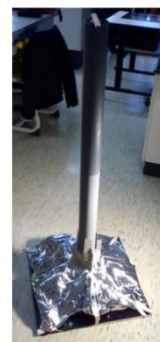
Bild 4/5: Aufwindkraftwerk mit Rettungsfolie gold / silber
