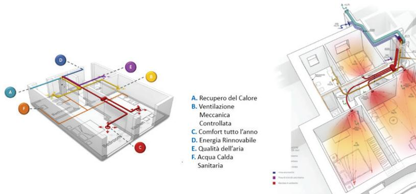
Fig. 24: integrazione dell' "Aggregato compatto" nell'involucro edilizio (fonte: CLIVET)
