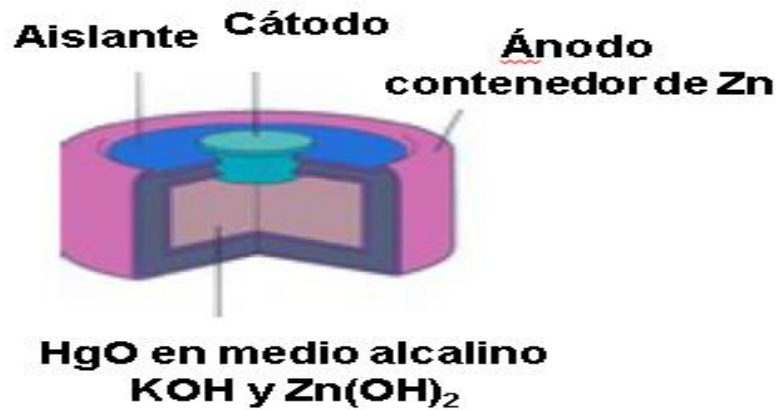
Figura 5.4. Pila de mercurio. El voltaje es aproximadamente de 1,34 V.
