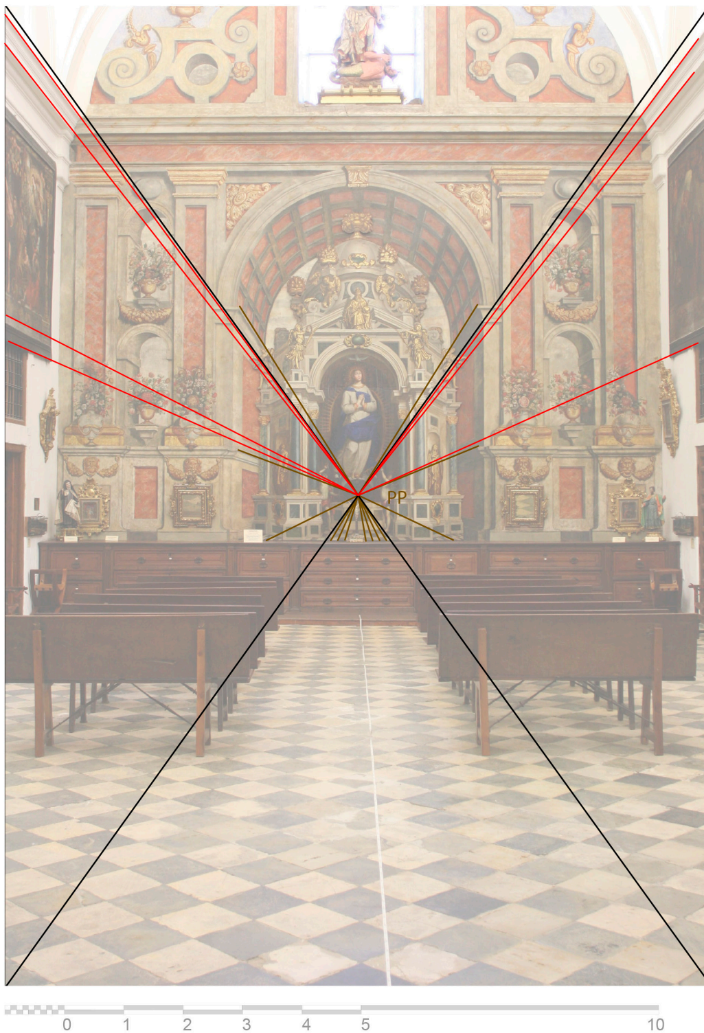
Fig. 31. Comprobación de que la cámara ha sido bien colocada, ya que las fugas de la estancia coinciden con las fugas de la pintura en el punto principal.
