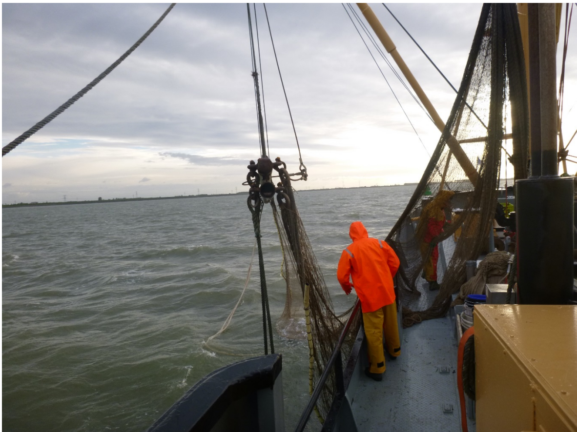
Het uitzetten van de ankerkuil (foto: I. de Boois)
