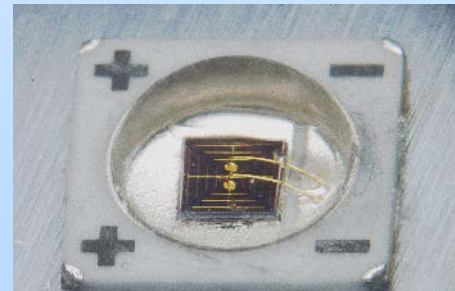
Optocoupler NASA GSFC PA Lab J16233
