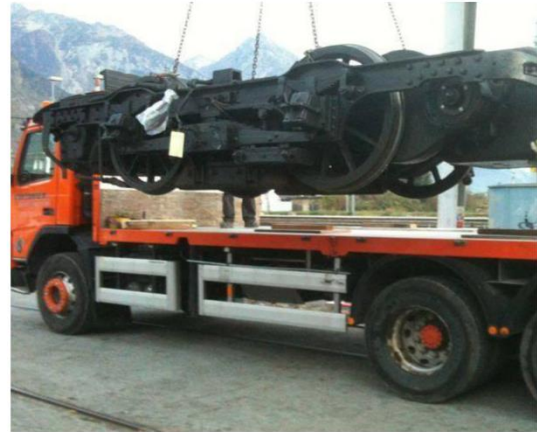
Automne 2011, transport des bogies par camion à Yverdon et démontage complet par les bénévoles du TNT
