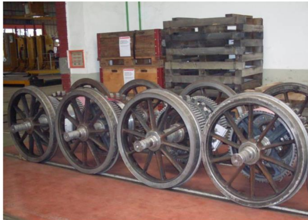
Contrôle et nettoyage des essieux par les ateliers des chemins de fer réthiques à Landquart en hiver 2012
