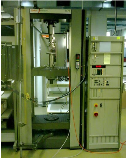
Figure 44 : Machine de traction ZWICK 1475 équipée du système de compression
