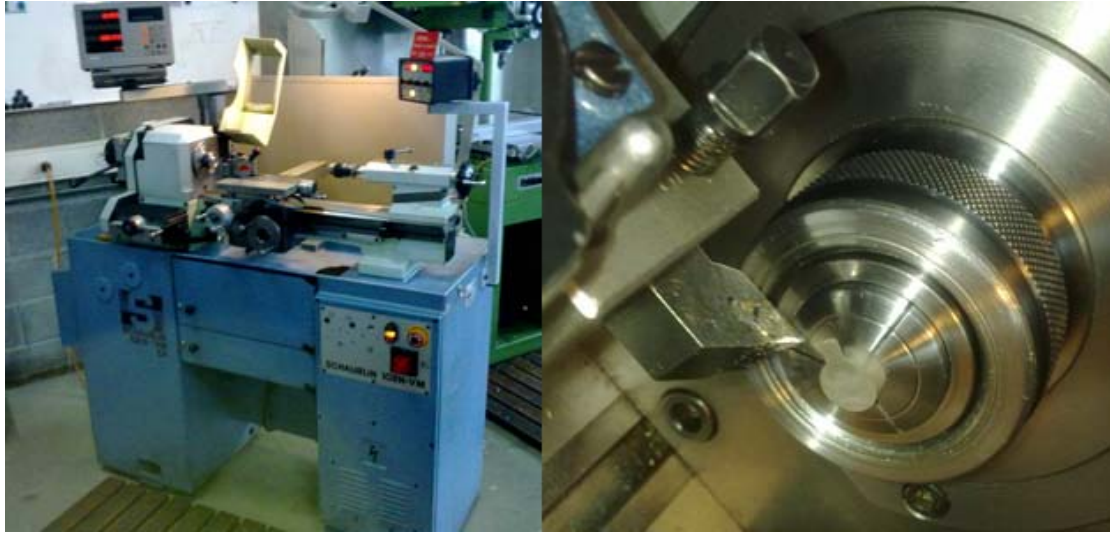
Figure 62 : Tour SCHAUBLIN 102N-VM, tournage d'un corps vert
