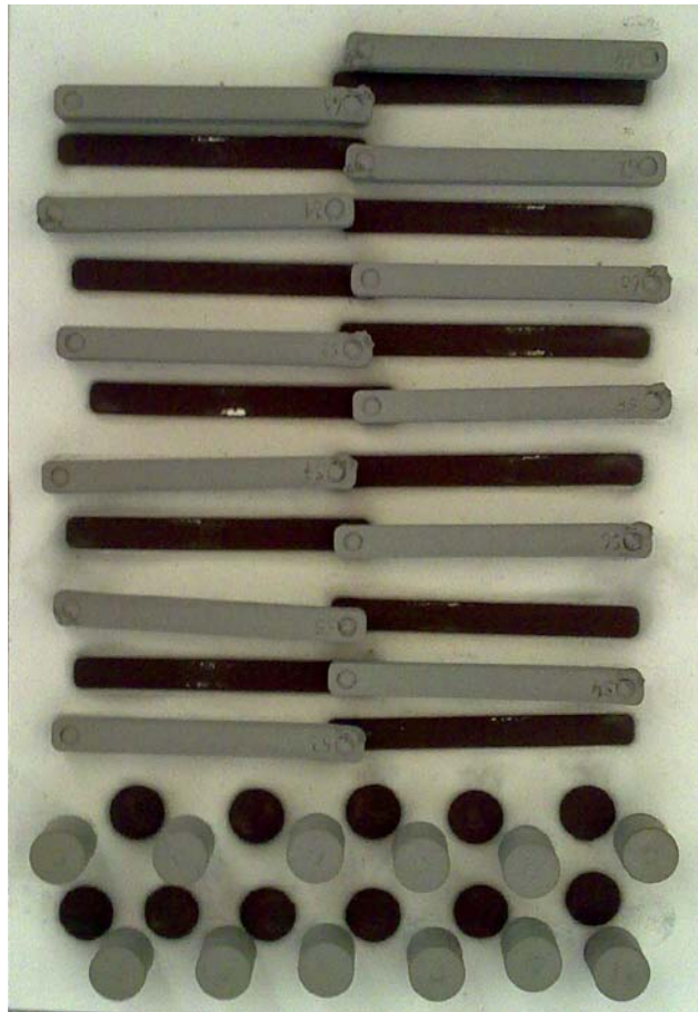
Figure 69 : Cycle de frittage 800°C – Corps frittés à la sortie du four
