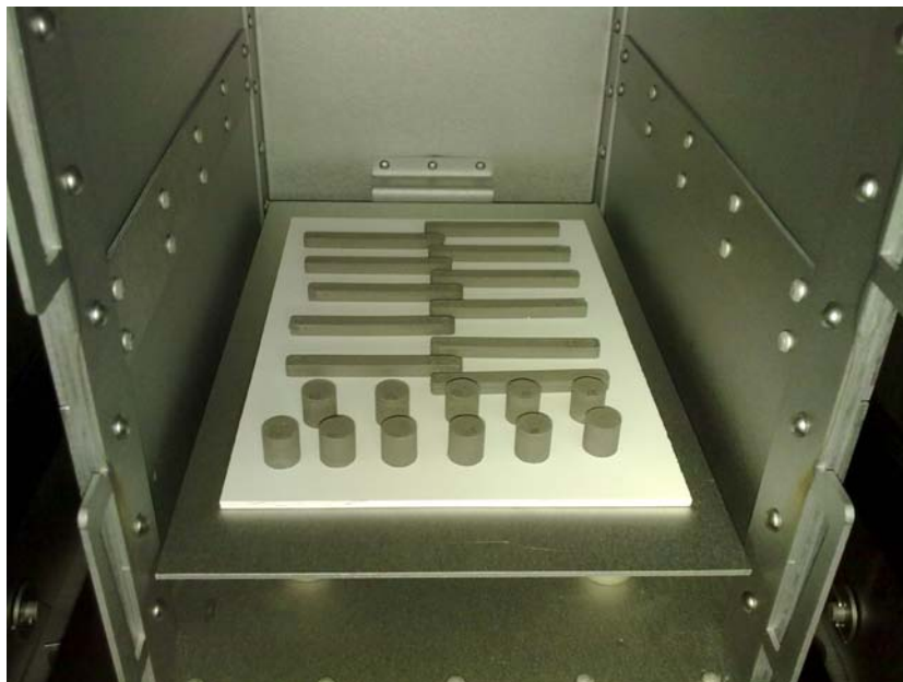
Figure 67 : Emplacement des corps semi-brun dans la chambre du four de frittage
