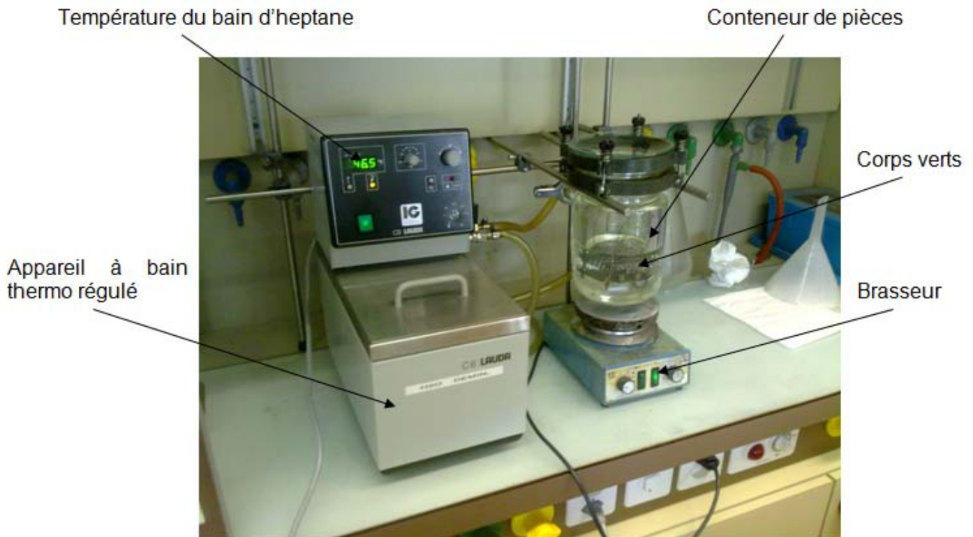
Figure 37 : Equipement de déliantage à bain thermo régulé
