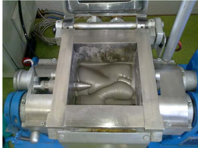
Figure 54 : Masse obtenue après 3h de mélange à 140°C
