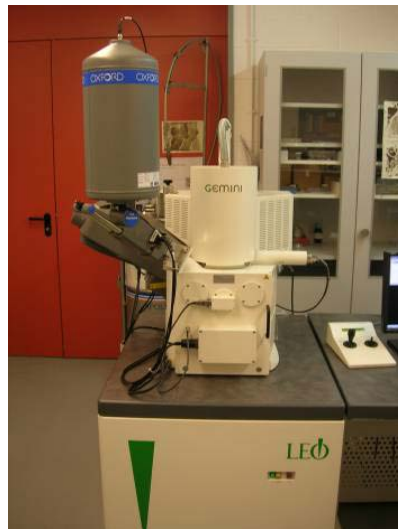
Figure 47 : Microscope électronique à balayage LEO 1525
