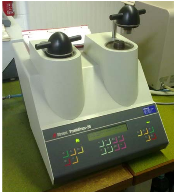
Figure 41 : Machine d'enrobage Struers ProntoPress-20
