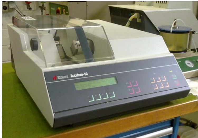
Figure 40 : Machine de découpe Struers Accutom-50
