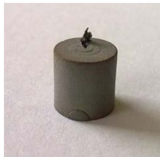
Figure 71 : Défaut visible sur la pastille n°58.
