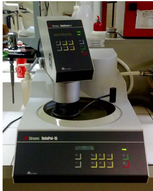
Figure 42 : Machine de polissage Struers RotoPol-15
