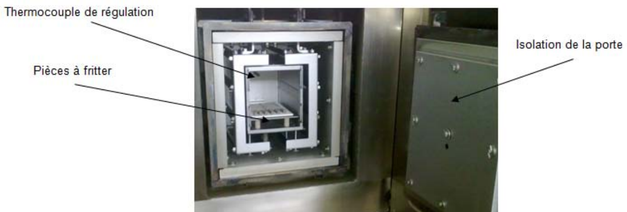
Figure 39 : Chambre du four NABERTHERM pour le déliantage et le frittage des pièces /12/
