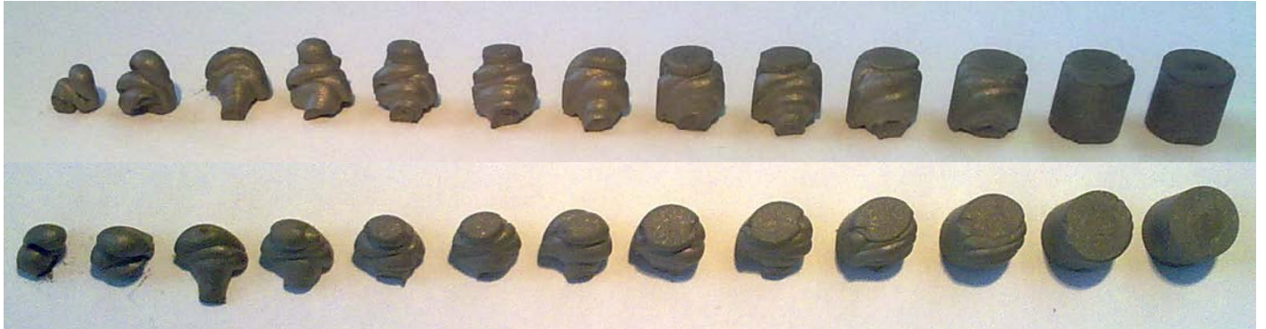
Figure 61 : Remplissage du moule, corps verts vus de côté et vus de dessus
