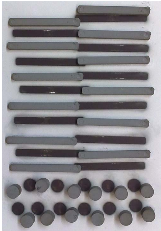
Figure 70 : Cycle de frittage 1000°C – Corps frittés à la sortie du four
