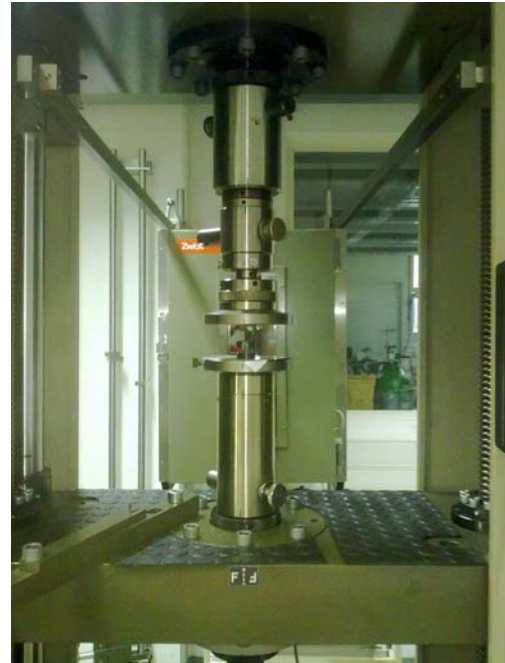
Figure 44 : Machine de traction ZWICK 1475 équipée du système de compression
