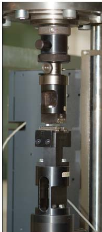
Figure 99 : Machine de traction ZWICK 145570 équipée pour la flexion 3 points
