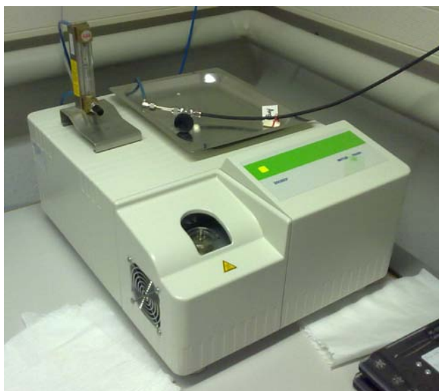
Figure 46 : Appareil METTLER TOLEDO DSC 823 e et container d'azote liquide
