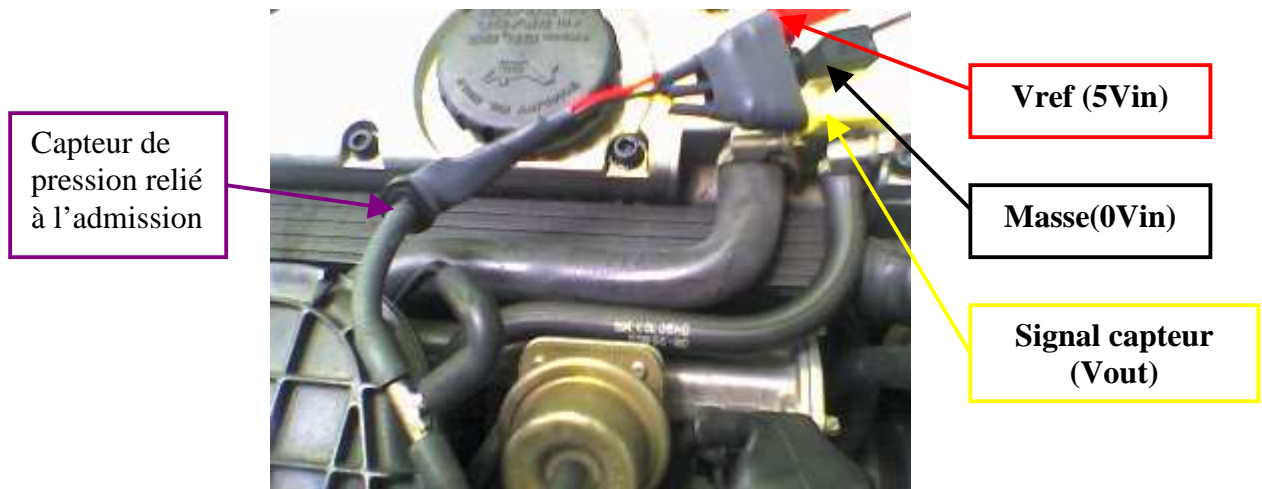
Figure 11.3-3 Montage capteur de pression
