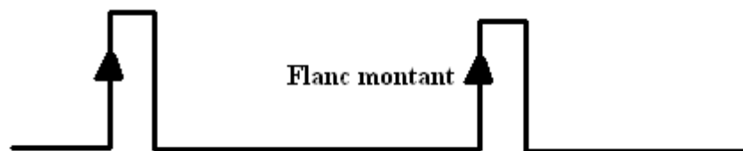
Figure 9.1-1 Signal capteur arbre à came flanc montant
