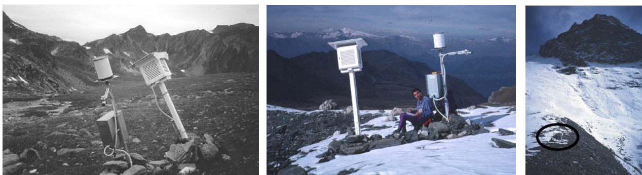
Fig. 5.9 A gauche, station MADD 143 (2610 m.s.m.), à l'aval du front du glacier rocheux des Becs-de-Bosson. Cette station, installée en 1988 par TENTHOREY (1993) et endommagée par le « poids » de la neige au printemps 2000 (à gauche) a été modifiée et déplacée sur le front du glacier rocheux en août 2000. Au centre et à droite (cercle), la station MADD 142 (2795 m.s.m.) dans les racines du glacier rocheux.
