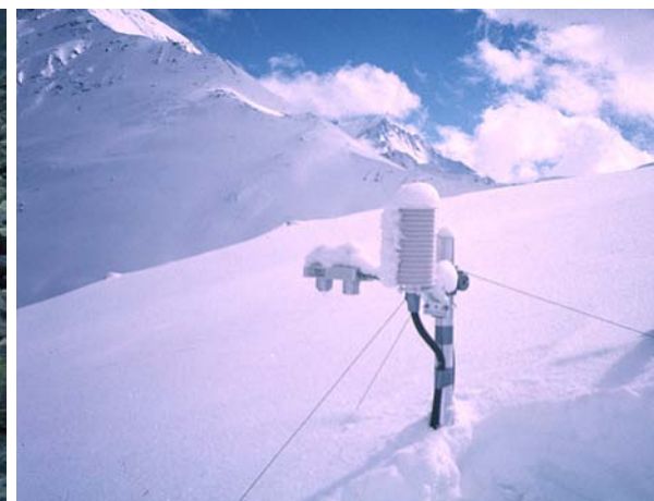
Fig. 5.6 Mini-station climatique MADD sur le glacier rocheux des Savoires (Alpage de Mille). A droite : lors de périodes très enneigées (ici en février 1999, ce fut le cas également en février 2003) la sonde thermique se trouve très proche de la surface de la neige et de ce fait, mesure par temps clair des températures «anormalement» basses (cf. fig. 5.1).
