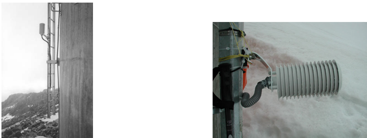
Fig. 5.8 Capteur de température de l'air aux Lapires. A gauche : pour être protégée des avalanches, la sonde est installée à l'aval du pylône P10, à 2.5 m de hauteur. A droite : en 2001, plusieurs avalanches se sont arrêtées durant l'hiver au niveau du pylône, augmentant considérablement l'épaisseur de neige; en avril, la sonde a ainsi été enfouie sous la neige; elle a ensuite été pliée par le tassement du manteau neigeux.
