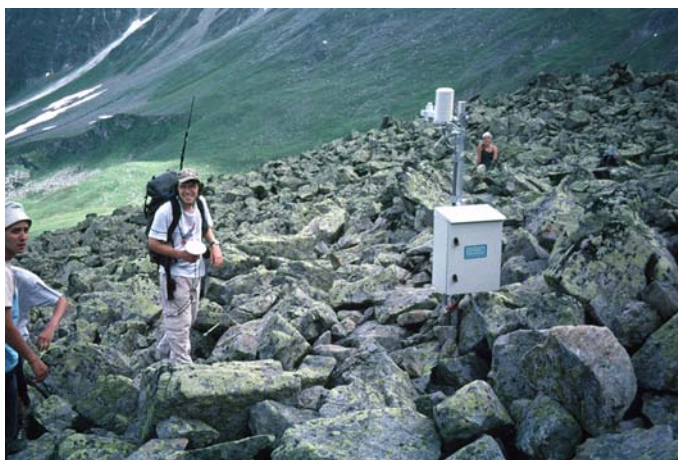
Fig. 5.6 Mini-station climatique MADD sur le glacier rocheux des Savoires (Alpage de Mille). A droite : lors de périodes très enneigées (ici en février 1999, ce fut le cas également en février 2003) la sonde thermique se trouve très proche de la surface de la neige et de ce fait, mesure par temps clair des températures «anormalement» basses (cf. fig. 5.1).
