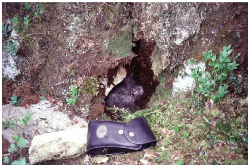
Fig. 7.7 A gauche : la Pessière à Tofieldie et la station MADD. A droite : présence de glace à proximité de la surface (19 juin 2002 par une température de +28°C) dans un canal d'aération de l'éboulis situé au tout premier plan de la photo de gauche. La température du sol (Soil temp.) est mesurée 10-20 cm à gauche du canal. La température de l'air pénétrant ou sortant de l'éboulis (Channel temp.) est par contre enregistrée au pied du MADD.
