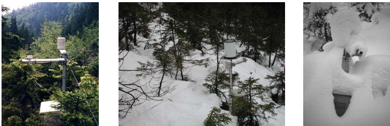
Fig. 5.7 Mini-station climatique MADD au Creux du Van. A droite : lors de grosses chutes de neige (ici en février 2003), en l'absence habituelle de vent, la station s'encapuchonne de neige fraîche; cette situation disparaît dès qu'un redoux s'installe.
