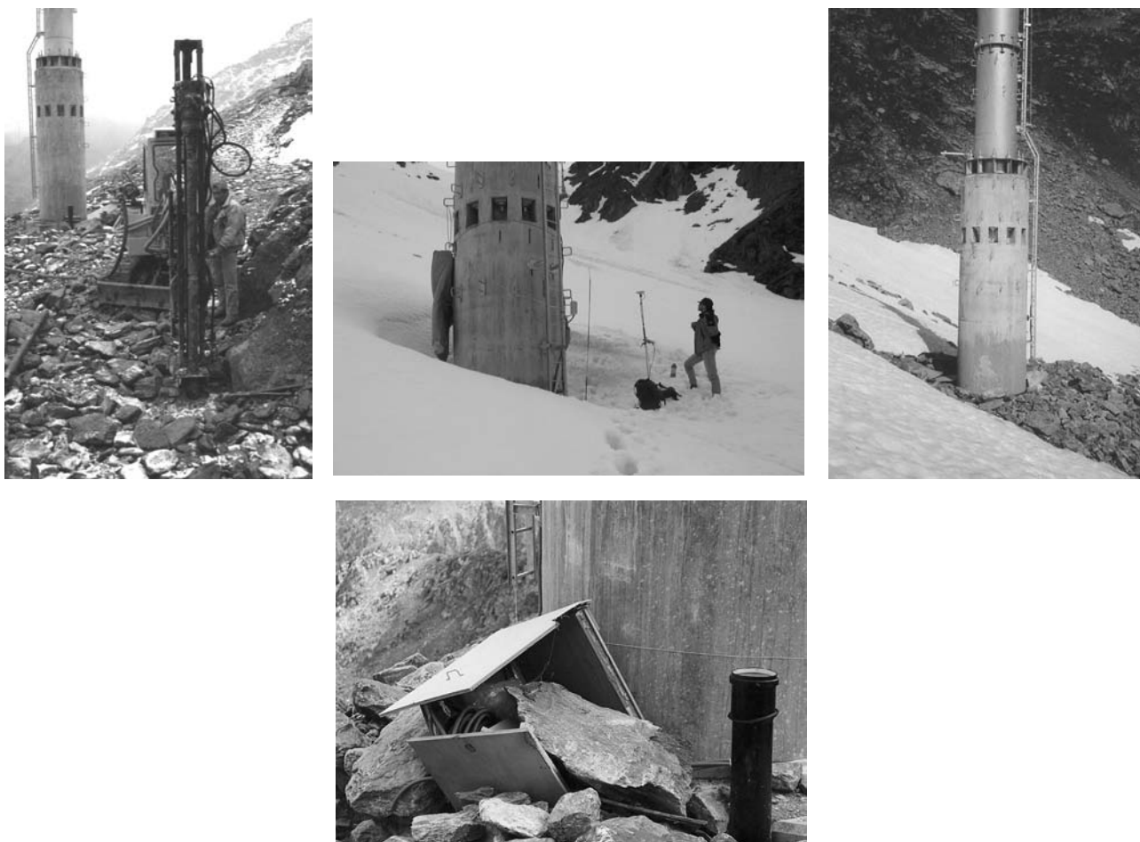
Fig. 3.32 Pylône P10 (Lapires, 2500 m.s.m.). A gauche : réalisation du forage en octobre 1998 (photo : E. REYNARD) à 16.5 m à l'W de P10. Au centre : épaisseur de neige restreinte autour de P10 (19 juin 2001). A droite : fonte accélérée de la neige autour de P10 (23 juin 2000). En bas : incident survenu en août 1999 ! Le module d'enregistrement des données se trouve sous le bloc, dans une caisse métallique qui a heureusement supporté le choc.
