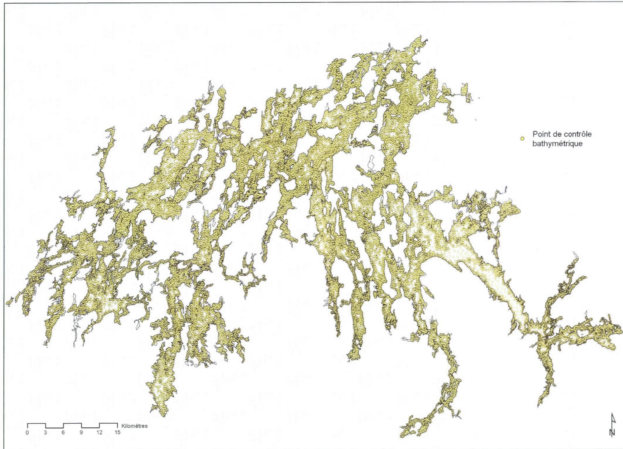
Figure 5.10 Répartition des 42 000 points de contrôle bathymétrique sur l'ensemble du réservoir Gouin.
