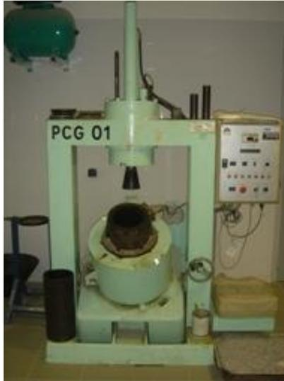
Figure 5 : presse à cisaillement giratoire
