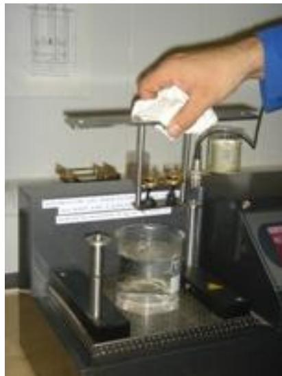
Figure 3 : Montage bille-anneau à la fin de la mesure
