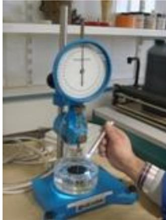
Figure 1 : Détermination de la pénétrabilité d'un échantillon de bitume
