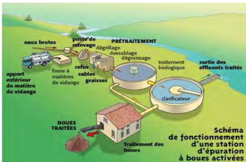
Figure 3. 1. Organisation et fonctionnement d'une station d'épuration
