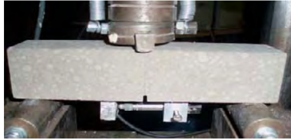
Figure III.31- Principe de mesure de la force en fonction de l'ouverture de fissure
