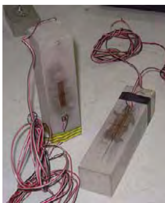
Figure A.4- Mesure des déformations en surface et dans le cœur de l'éprouvette pour un mortier industriel (formule commerciale pour travaux de chapes) en ambiance contrôlée
