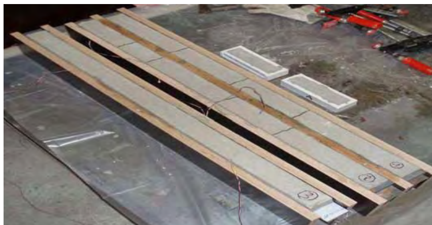
Figure II.50 - Aperçu des maquettes et des prismes pour le suivi des déformations, de la fissuration et de la perte de masse
