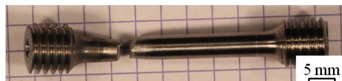
Figure III.40 - Photographie d'une éprouvette après traction à 20°C présentant une striction (déformation localisée) conduisant à la rupture
