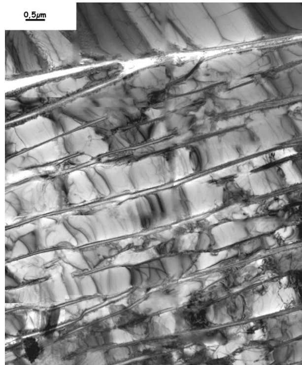
Figure III.12 - Micrographie en transmission d'une colonie lamellaire au cœur du galet
