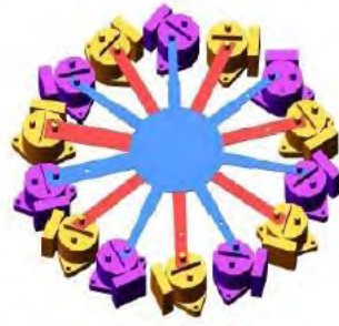
Fig 5-7: Bus continu de l'armoire d'interconnexion
