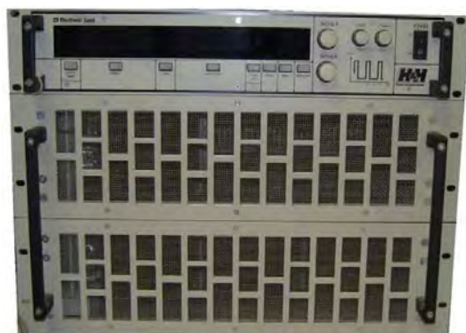
Fig 5-20: Charge électronique H&H pour l'émulation de l'électrolyseur
