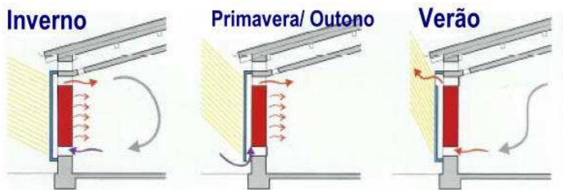
Figura 5. Esquema de funcionamento de uma parede de Trombe. Fonte: (Gonçalves, 1997).
